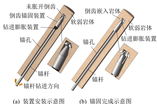
图 2 物理锚固装置主要工作过程
